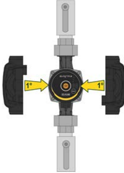
Resim 7: Pompa gövdesinin yalıtımı
