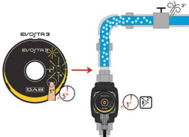
Obrázek 9: Automatické odvzdušnění čerpadla
