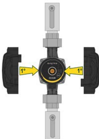
Fig 7: Isolering av pumphuset
