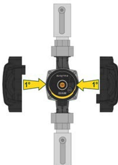
Figura 7: Isolamento do corpo da bomba
